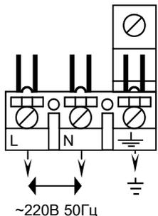
Подключить сетевой кабель согласно маркировке на клеммной колодке.
